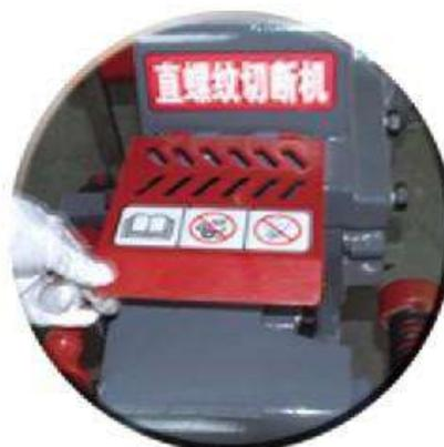
2.4.2 Поднимите крышку ножа, переместите арматуру с помощью подающего механизма
