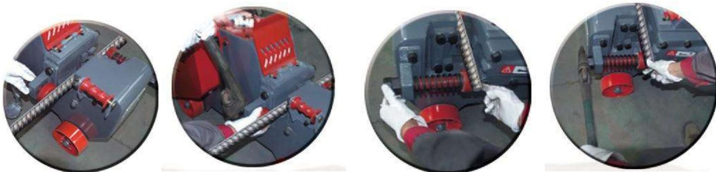
**2.4.4** Опустите крышку ножа, затем передвиньте рычаг управления рукой или ногой, лезвие готово к использованию. Примечание: время переключения рычага управления не должно превышать 2 секунды каждый раз, иначе резка будет неравномерной.
